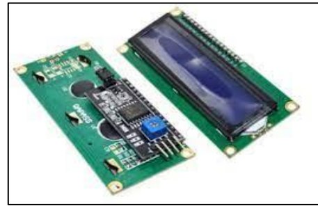
Figure 3.11 : Afficheur LCD interfacé avec I2C.
