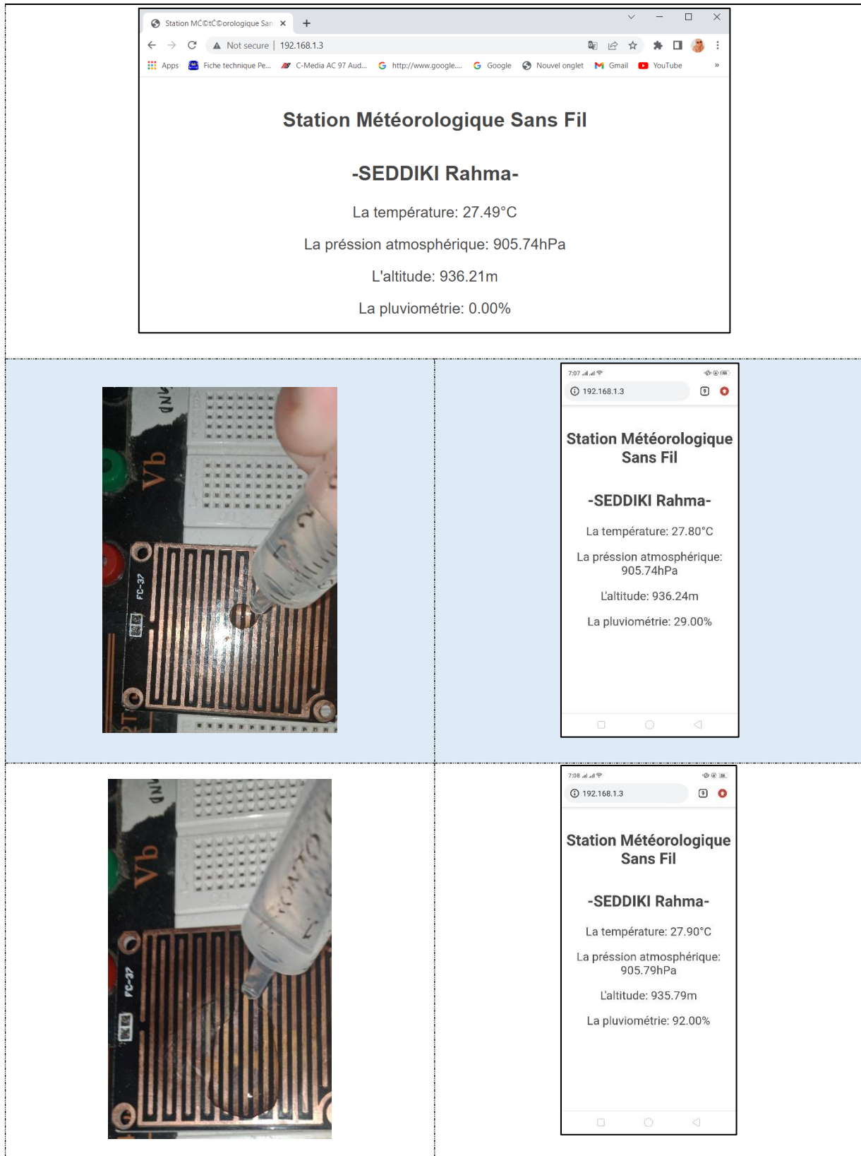
Figure 3. 28 : Résultat obtenu de la réalisation pratique du Station météorologique.
