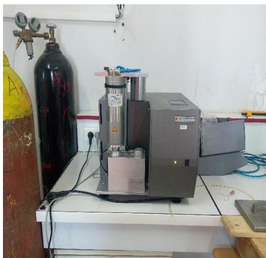
Figure 16: schéma et appareil d'analyse thermogravimétrique ATG
