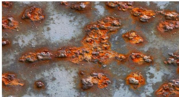
**Figure I.14:** Corrosion intergranulaire
