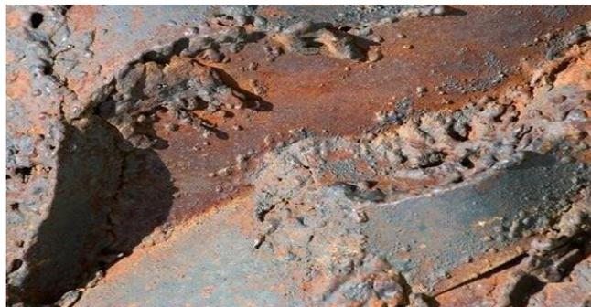
**Figure I.15 :** Corrosion érosion.
