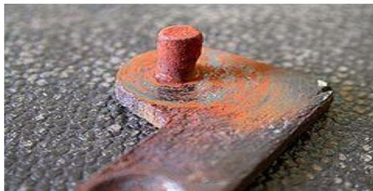
**Figure I.8 :** Corrosion accompagnée d'usure.
