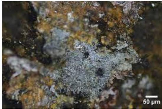
**Figure I.7:** Corrosion biochimique (bactérienne).
