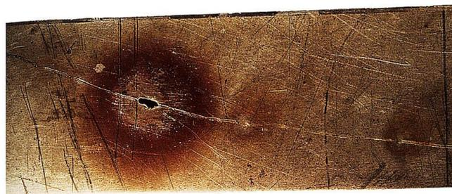
**Figure I.13** : Piqûres de corrosion.
