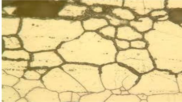
**Figure I.16** : la corrosion sous contrainte.
