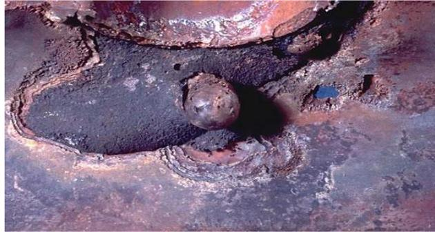
**Figure I.11** : la corrosion galvanique.
