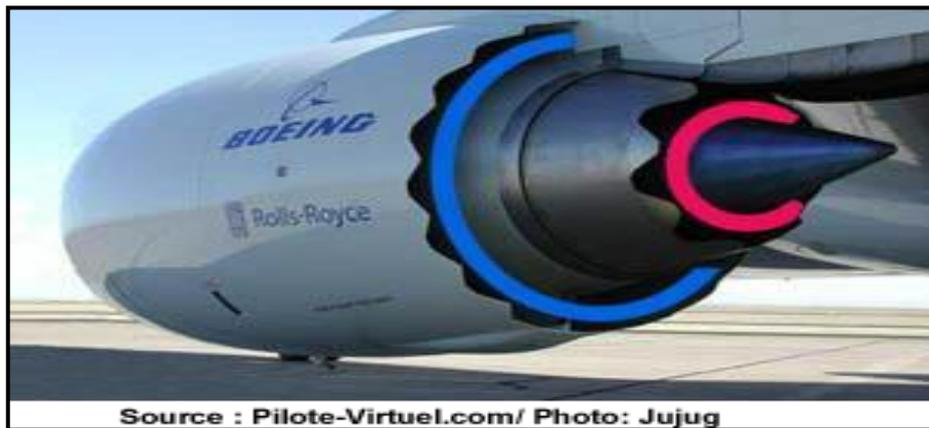
**Figure I- 5 :** Tuyère à chevrons (tuyères en dents de scie)
