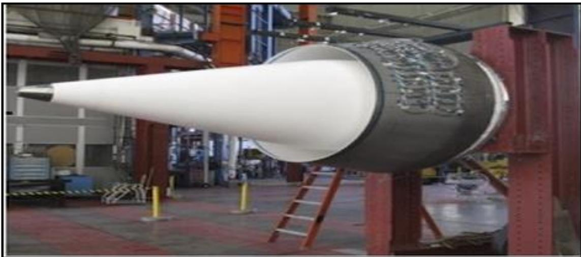
Figure I-3 : Tuyère à noyau central
