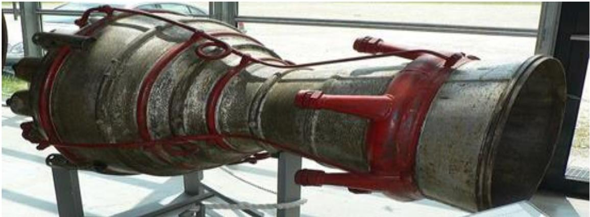
situe entre 15 et 25 degrés. Ce type de profil simple équipe principalement les missiles et les propulseurs à poudre. Un exemple de tuyère conique est la tuyère de la fusée historique allemande V-2
