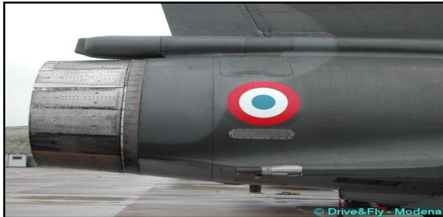
**Figure I-4** : Tuyère à section variable
