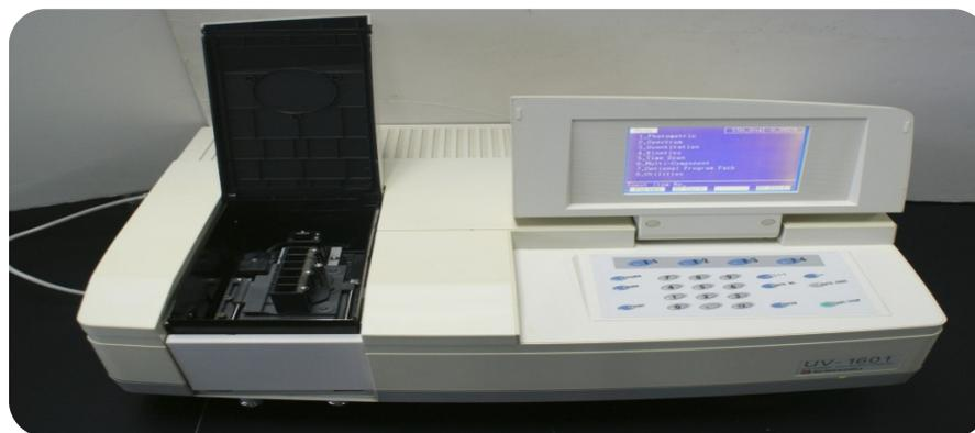
Figure II-2. Schéma de l'appareil UV-VIS (Shimadzu UV-1800 spectrophotomètre).
