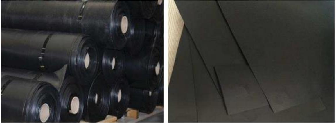
*Fig.I.4.géo-membrane polyéthylène haute densité [19].*
