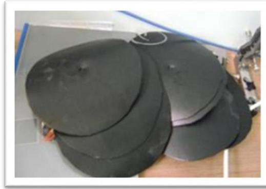
*Fig. III.4. Eprouvettes Pour L'essai De Poinçonnement.*
