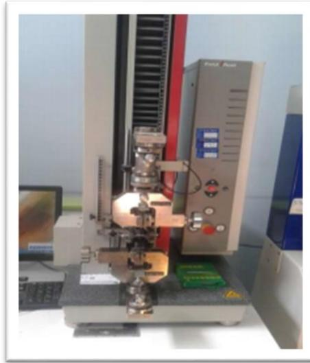
*Fig.III.2. Éprouvette De Traction Mécanique.*
