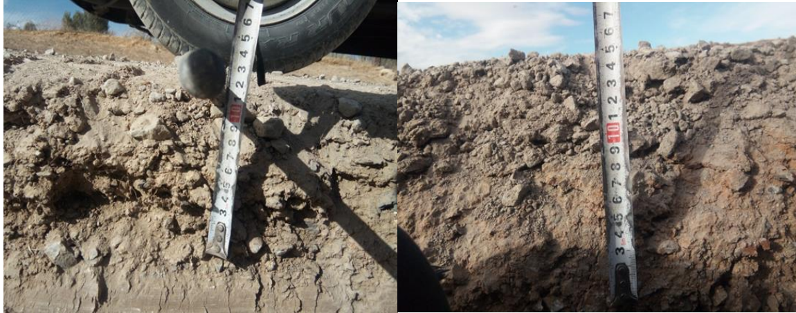
Figure III. 5 Sondage à ciel ouvert
